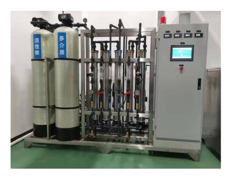
超纯水设备制备工艺: 1、预处理系统→反渗透系统→中间水箱→粗混合床→精混合床→纯水箱→纯水泵→紫外线杀菌器→抛光混床→精密过滤器→用水对象 □≥18MΩ.CM□(传统工艺); 2、预处理→反渗透→中间水箱→水泵→EDI装置→纯化水箱→纯水泵→紫外线杀菌器→抛光混床→0.2或0.5μm精密过滤器→用水对象□≥18MΩ.CM□(新工艺); 3、预处理→一级反渗透→加药机□PH调节)→中间水箱→第二级反渗透(正电荷反渗膜)→纯水箱→纯水泵→EDI装置→紫外线杀菌器→0.2或0.5μm精密过滤器→用水对象□≥17MΩ.CM□(新工艺); 4、预处理→反渗透→中间水箱→水泵→EDI装置→纯水箱→纯水泵→紫外线杀菌器→0.2或0.5μm精密过滤器→用水对象□≥15MΩ.CM□(新工艺); 5、预处理系统→反渗透系统→中间水箱→纯水泵→粗混合床→精混合床→紫外线杀菌器→精密过滤器→用水对象□≥15MΩ.CM□(传统工艺)以上工艺各有各的优势,你可以根据你自身的情况选购适合你的工艺。随着科学的发展,很多新的工艺已经替代了旧的工艺,反渗透法制取高纯水已经普及,也是较为先进的工艺。
