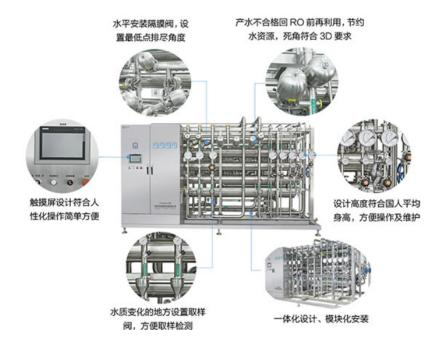
GMP认证用纯化水设备电法去离子: 电法离子交换系统□EDI□亦是一种离子交换系统,这种离子交换系统 使用一个混合树脂床,采用选择性的渗透膜以及充电器,以保证水处理的连续进行和树脂的连续再生。处理工艺为,原水首先进入树脂段,当水通过树脂时,被脱去金属电荷离子,成为产品水。这种系统使用的树脂可以看作为一个导体,在电位势能的作用下,迫使被俘获的阴、阳离子通过树脂和渗透膜而浓缩,并从水流中脱出。与此同时,在树脂段中,电位的势能又将水电解成氢离子和氢氧根离子,从而使树脂得以连续再生,且不需要添加再生剂。大型超纯水器厂商反渗透纯水设备主机主要由增压泵,反渗透膜,膜壳,控制电路等组成。
